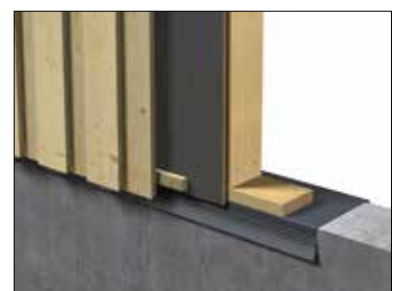
Övergång mellan vägg och grund
